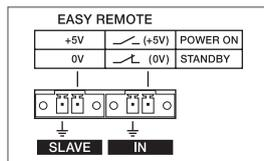
Über Easy-Remote kann die Endstufe auf einfache Weise ferngesteuert ein- und ausgeschaltet werden. Die Easy Remote Funktion kommt nur bei Geräten ohne RCM-24 Modul zum Tragen.
